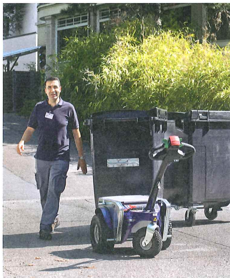
L'acquisition d'un tracteur de remorquage pour l'évacuation des déchets a permis de réduire la charge physique du personnel d'entretien.
